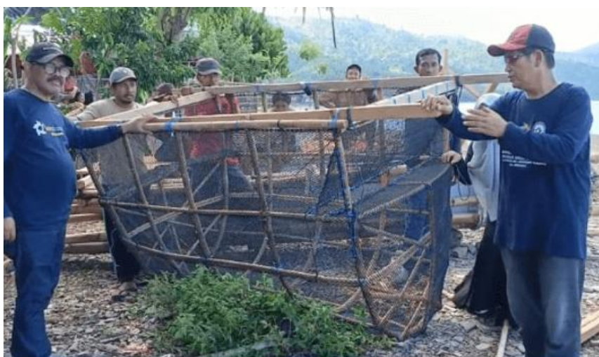
Gambar 4. Rangka kalase yang sudah siap dipasangkan ke rompong
