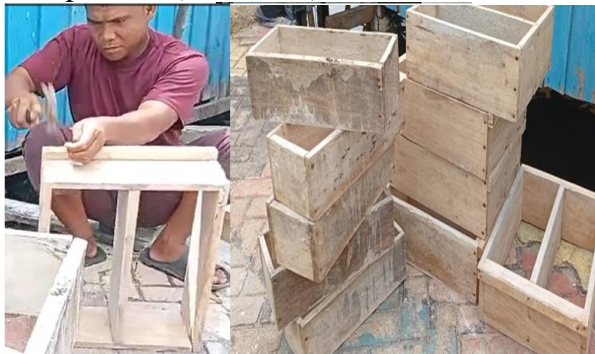
Gambar 7. Pembuatan Cetakan Balok dari papan berbentuk persegi panjang dengan ukuran 40 x 15 cm 2 dengan tinggi 20 cm oleh peserta
