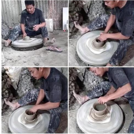
Gambar 5. Proses membentuk tanah liat menjadi gerabah
