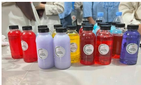
Gambar 4. Produk deterjen cair hasil praktek berbasis SLES (kiri) lebih keruh karena terdapat banyak busa dan MES (kanan) terlihat lebih jernih karena bersifat rendah busa
