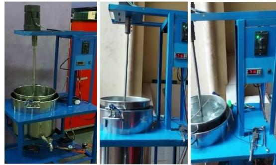
Gambar 43. Alat Pelaksanaan Uji Coba Pemanas dengan Menggunakan Sistem Double Jacket
