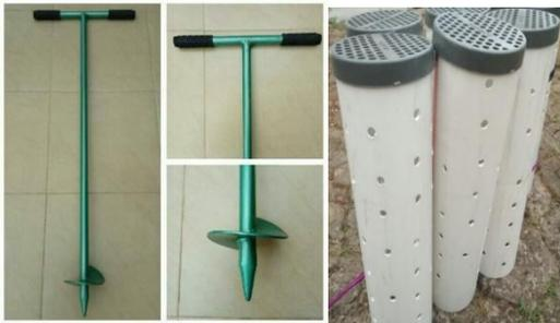
Gambar 1. Bor tanah dan pipa PVC yang sudah dilubangi
