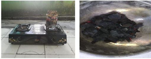
Gambar 1. Pembuatan arang dari tempurung kelapa
