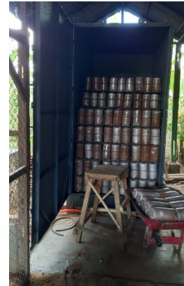
Gambar 4. Sterilisasi Baglog: alat Steamer dengan kapasitas 1.000 baglog
